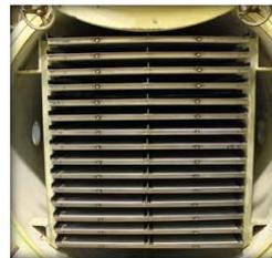
バットを乾燥機に入れ凍結乾燥します。
