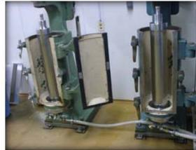
遠心分離機により沈殿物を取り除きます。
