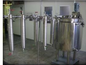
段階的に除菌フィルターを通し、最終的には0.2 $\mu$ のフィルターで除菌します。
